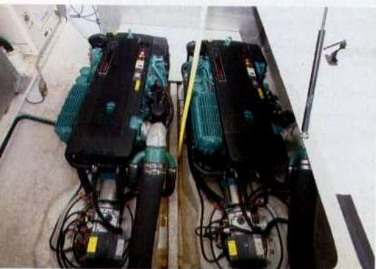
Di generose dimensioni, la cala motori ospita due Volvo Penta IPS 600.
