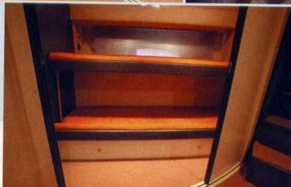
Sopra, il secondo divano del quadrato, appoggiato alla murata di dritta. A fianco, alzando lo schienale del divano si ottengono due cuccette sovrapposte; questa zona, per la notte, può essere chiusa grazie a una paratia scorrevole.
